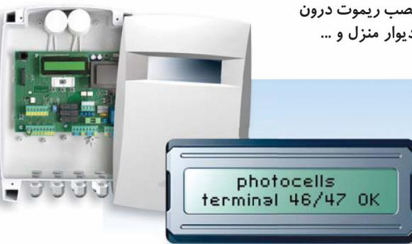
« مدار کنترل دارای LCD نورانی در دو سطح جهت نمایش وضعیت جک ، فرامین ، عملکردها و خطاهای دستگاه « امکان مشاهده LCD در هنگامی که درب مدار کنترل بسته است ( جهت ساختن ساختمان ) « نمایش متن کامل پیام ( عدم استفاده از کد های اختصاری ) « دارای برنامه های گوناگون حرکتی از جمله لحظه ای ، اتوماتیک ، تک لنگه ، نیمه باز ، اسباب کشی و ...
