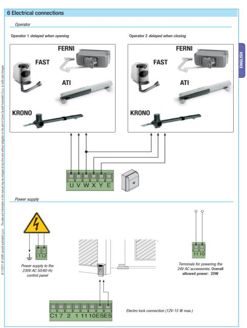
جک شماره یک به VVW در این حالت سیم مشترک به W وصل می شود جک شماره دو به XVW وصل می شود در این حالت نیز W سیم مشترک یا آبی رنگ است قفل برقی به کانکتور های ES ES وصل میشود.
