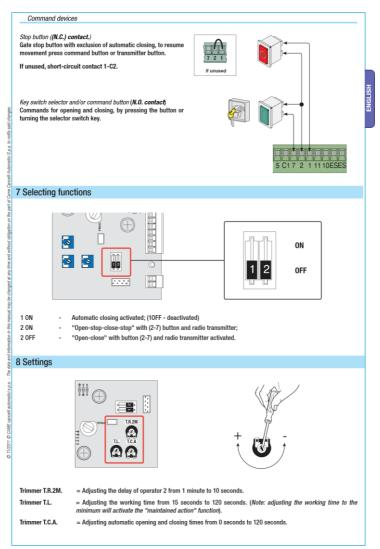
دیپ سوئچ یک ON شود اتوماتیک بسته شدن فعال می شود.
